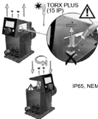
Рис. 7 Регулювання панелі управління
