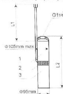
Рис. 1 Габаритні та приспудувальні розміри 1 – насосна частина, 2 – фільтр, 3 – електродвигун,
