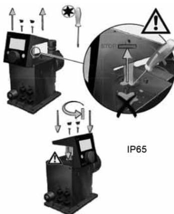
Рис. 6 Регулировка положения блока управления
